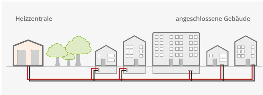
Abb. 1: Aufbau eines Wärmenetzes
