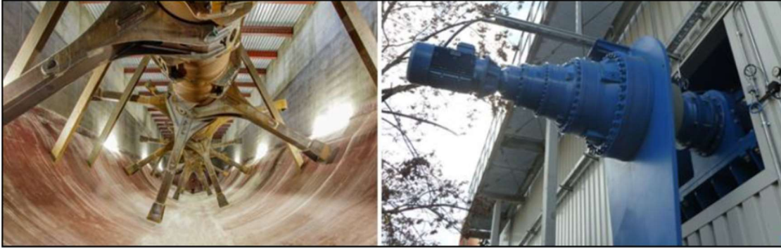
Abbildung 8: Darstellung Rührwerk und außen liegendes Planetengetriebe
