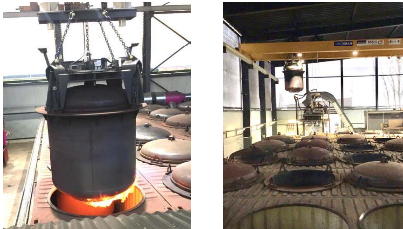
Abbildung 5: Abkühlen der gefüllten Retorten ohne zusätzliche Wassernutzung
